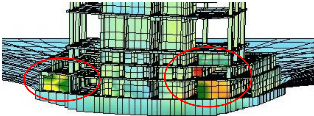
Abbildung 16: Ungünstig beanspruchte Wände
